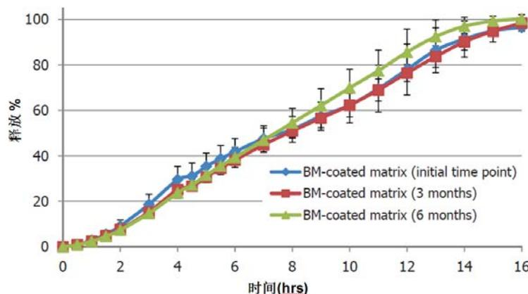
图 5. HCTZ 含有善达做为填充剂的 2%增重膜控包衣的骨架片(200mg)在 30°C/65%RH 条件下贮存后的释放曲线。
