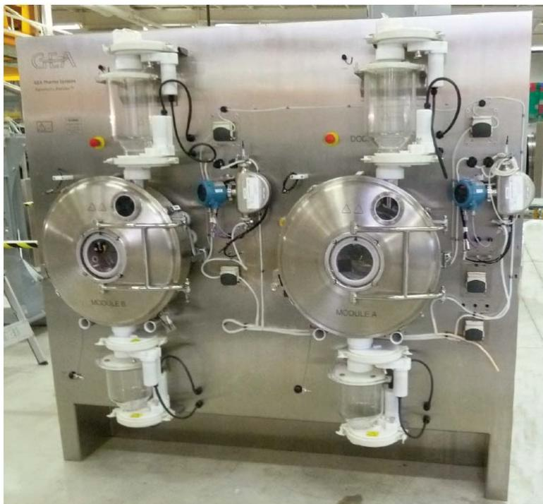
本项研究中，片剂自动注入单个包衣模块中，在每个包衣周期结束时，以半连续式包衣工艺自动卸料。单个包衣室装置如图3所示。
