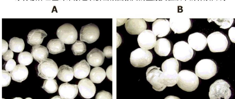
图3 溶出实验后用(A)有机溶液乙基纤维素和(B)水分散体乙基纤维素包衣的微丸显微镜像
