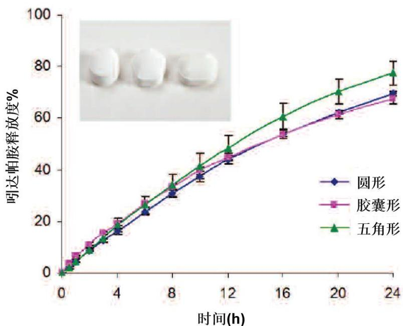
注：三种片形的吲达帕胺骨架片片重均为 200mg。溶出实验采用带沉降篮的 USP I 法(篮法)，转速 100rpm，介质为 0.05M pH6.8 磷酸盐缓冲液 900ml(n=6)。
