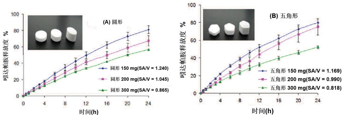
注：溶出实验采用带沉降篮的 USP I 法(篮法)，转速 100rpm，介质为 0.05M pH6.8 磷酸盐缓冲液 900ml，(A)为圆形片，(B)为五角形片(n=6)。
