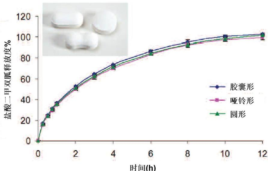
注：三种片形的盐酸二甲双胍骨架片片重均为 1000mg。溶出实验采用带沉降篮的 USP II 法(桨法)，转速 100rpm，介质为纯水 1000ml(n=6)。
