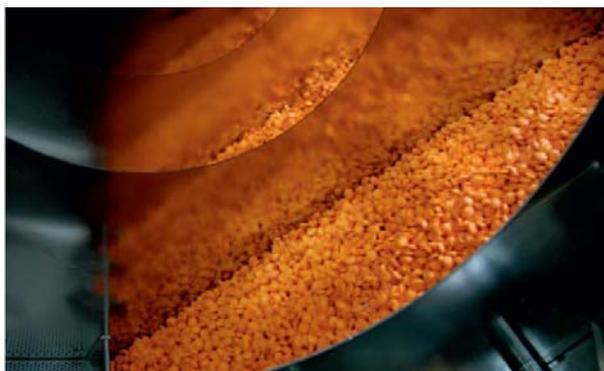
本研究对一个固含量可高达 35% 的新型薄膜包衣配方，在连续循环包衣过程中的性能进行了评估。共进行了四个实验，并对每个实验包衣片包衣增重的一致性、颜色的均匀度、片面的粗糙度和光泽度进行了评估。
