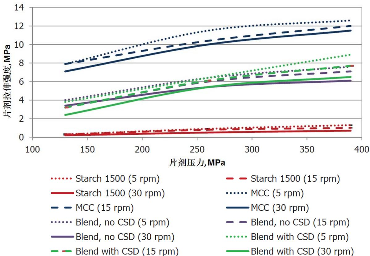
图 2.表明含有咖啡因的混合粉末虽然片剂强度减少,但在压片力为 10kN(260MPa)或 15kN(390MPa)时,仍能获得稳健配方。和之前的趋势相似,片剂强度在高压制速度时下降,含微粉硅胶的片剂稍有下降,特别是在 15kN(390MPa)时。10%氢氯噻嗪片(25mg 剂量, 10%含药量)的制备和物理检测。
