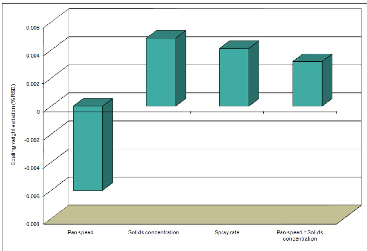
锅速增加使得包衣重量差异降低，而固含量及喷液速度增加使得包衣重量差异增大。20 次试验的重量均匀度数据分析支持色泽均匀度结果。较高的喷液速度结合较高的固含量使得包衣均匀度下降；然而，如果结合较高的锅速，则可限制这些影响。生成了响应面图来考察按 3.0%增重，固含量增加时锅速和喷液速度对包衣重量差异的相互影响（图 4-6）。
