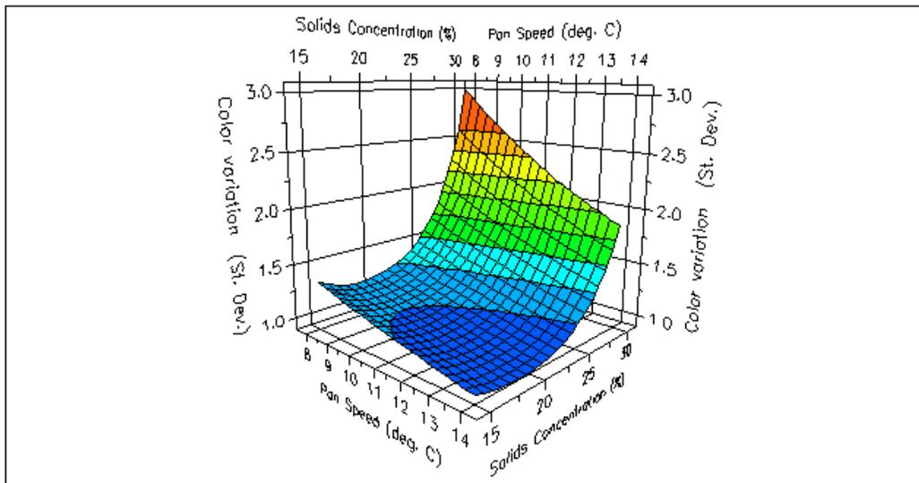
低包衣浓度时，随着包衣分散系的固含量增加，片剂的色泽均匀度下降。该影响主要是包衣时间导致的。固含量最高及喷液速度最高的批次导致工艺时间极短（喷涂至理论的 3%增重的时间短至 20 分钟），并且使得片剂均匀出现在喷液区的机会减少。增加锅速在某种程度上可减轻该影响，因为增加锅速可让片剂更经常出现在喷液区，并且可改善色泽均匀度。
