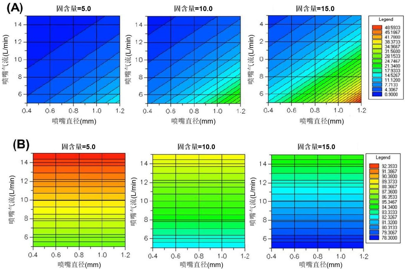
利用2D等值线图分析，确定能够影响固体分散体粒度和溶出率的工艺参数的变化。图5a和5b中的等值线图分别描绘了不同固含量下的喷嘴直径和喷嘴气流对平均粒度和药物释放的影响。高喷嘴直径，低气流以及高固含量的组合产生较大的粒度(>48.5µm)(图5a)；这就导致药物释放较慢：在15分钟内药物释放<78.3%(图5b)。反之，低喷嘴直径，高喷嘴气流以及低固含量的组合产生较小的粒度(<4µm)；这就导致药物释放较快：在15分钟时药物释放>92.4%(图5b)。
