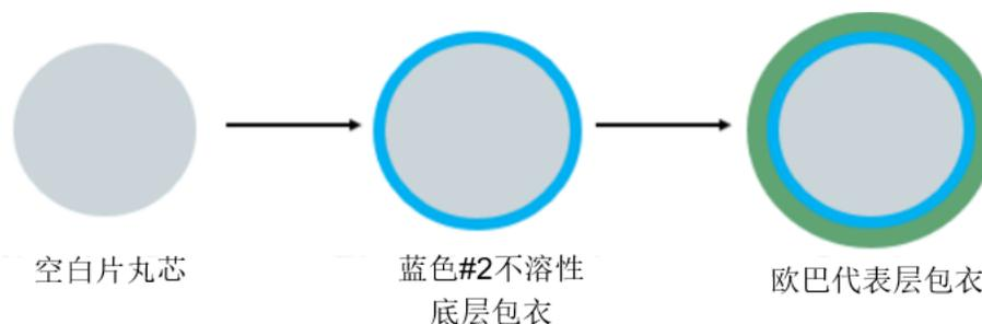
使用光稳定箱(Atlas Suntest XLS+, US)，将包衣片剂暴露在辐照度为250W/m<sup>2</sup>的波长范围300-800nm的光线下。所有样品均暴露9小时或22小时，以符合ICH紫外和可见光暴露标准。<sup>2</sup>
