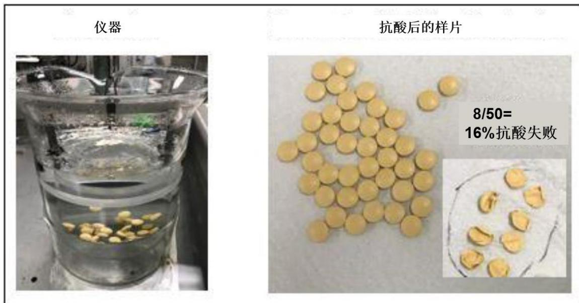
同时, 根据 USP 的阿司匹林肠溶片质量标准检测样品的释放度。
