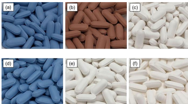
图2. 已标记和未标记的扑热息痛片通过储存在30°C/65% RH 12个月或40°C/75% RH 6个月稳定状态下的色差(DE)
