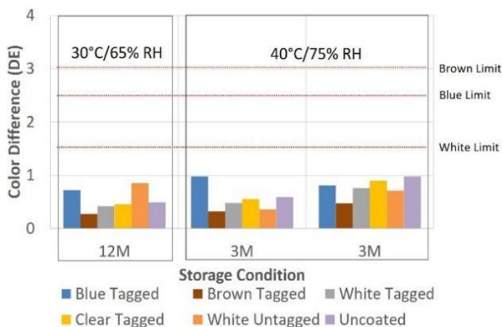
图2. 已标记和未标记的扑热息痛片通过储存在30°C/65% RH 12个月或40°C/75% RH 6个月稳定状态下的色差(DE)
