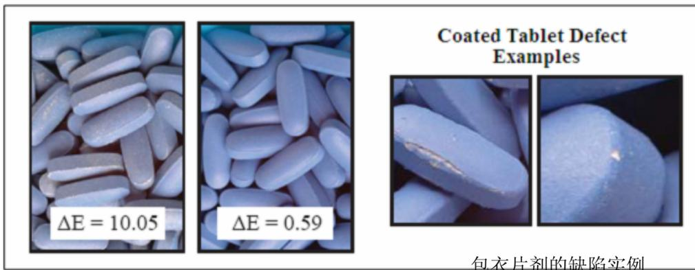
在 24”全孔包衣锅(O’Hara Technologies Labcoat II)中进行实验室规模包衣试验。在 48”全空包衣锅(O’Hara Technologies Fastcoat)中进行生产规模试验。两个包衣锅都装有 1.0 mm 喷雾系统 VAU 抗须状效应喷枪。全部试验的目标包衣重量增加为 3.0%。
