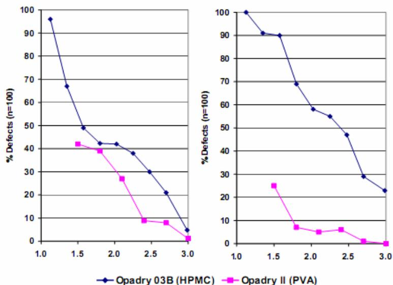
提高包衣锅速度引起使用以 HPMC 为基础的系统包衣的片剂的缺陷增加。以 PVA 为基础的薄膜包衣片剂的缺陷率整体较低，而且有意思的是，包衣锅的速度越高，使用以 PVA 为基础的包衣系统的缺陷越少。这些结果可能是由于所用薄膜的表面特性的不同。由 Hughes 等检查了不同包衣系统的摩擦属性。在他们的研究中，发现 PVA 基础包衣系统比 HPMC 系统具有更高度“润滑性”<sup>3</sup>。润滑性越高就可在片剂嵌入包衣锅内时对片剂提供更少的摩擦力，从而使隔板更有效的混合，摩擦力更小而缺陷更少。
