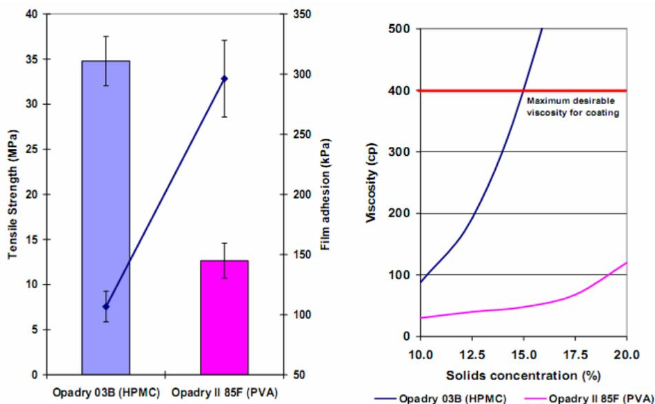
以前的研究都表明薄膜强度对降低包衣片剂边缘缺陷的发生率具有至关重要的作用。人们还认识到薄膜的粘附性发挥着同等重要的作用，稳定的包衣处方必须平衡每个因素。
