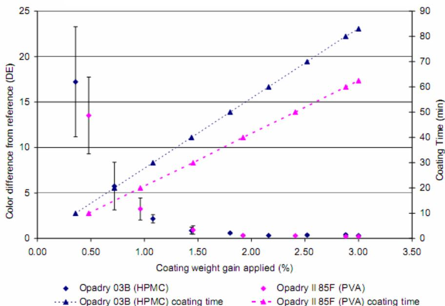
在生产规模下，根据应用包衣重量增加，两种包衣系统的上色均一。每种包衣系统都达到了目标颜色并且在应用的重量增加下，可接受的颜色均一性为<2.0%。由于所用混悬液的固体含量较低，利用以 HPMC 为基础的包衣系统的包衣试验再次花费的更长时间达到目标颜色。
