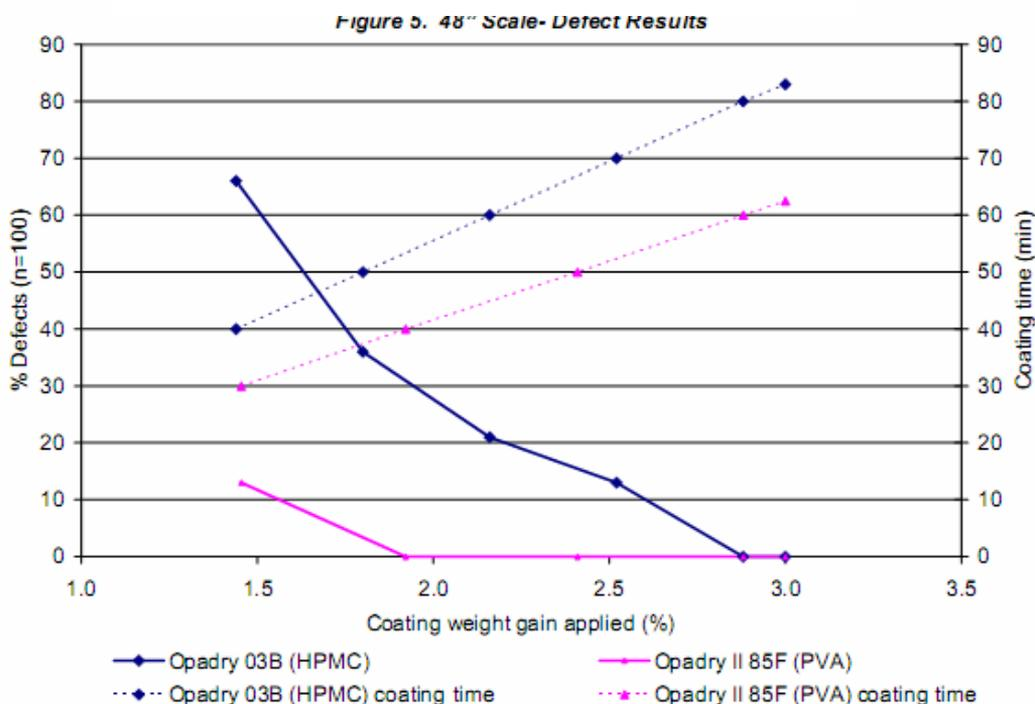
生产规模的 HPMC 和 PVA 基础包衣系统的缺陷率明显比试验规模所见缺陷率低。这与研究生产规模对片剂磨损的影响的 Mueller 等人的结果一致，他们假定更大的包衣锅负荷引起越少的片剂与锅壁和隔板的撞击 4。
