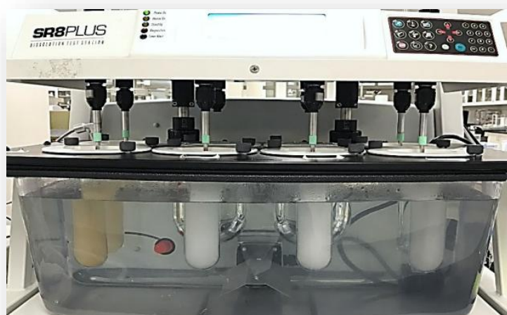
图 1. 用于高通量筛选的小体积溶出装置
