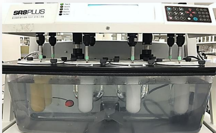
图 1. 用于高通量筛选的小体积溶出装置
