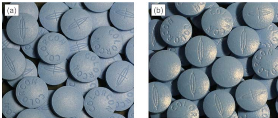
图 3: (a)未使用 和(b)使用在研透明薄膜衣系统的在研着色型薄膜包衣片
