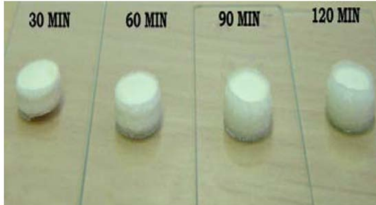
图 3.在溶出度测试过程中苏丽丝包衣骨架的膨胀和破裂
