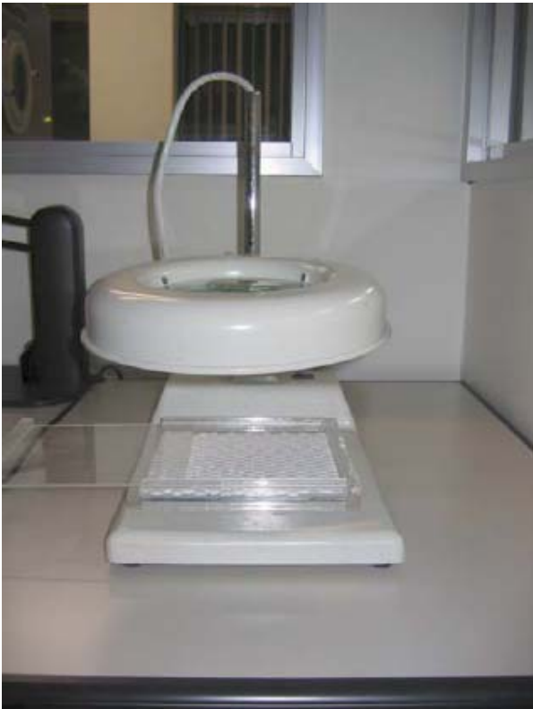
图 3 检测擦黑的装置
