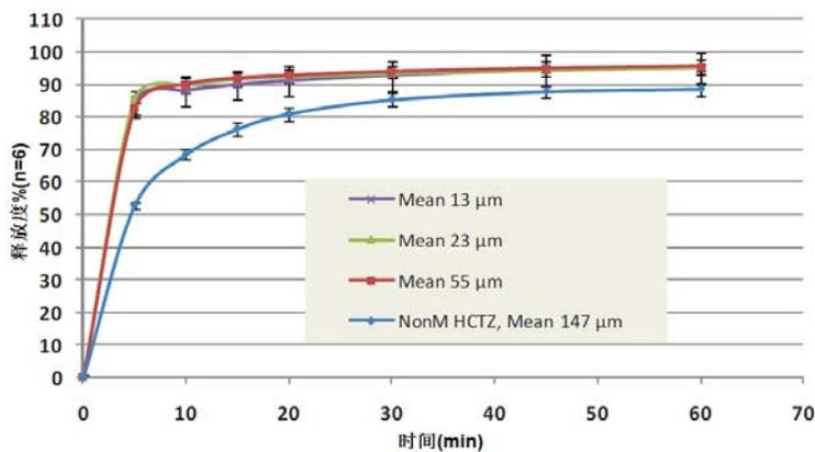
图 4. 含善达/微晶纤维素 1: 2 的 10% 氢氯噻嗪配方的溶出曲线比较(n=6)
