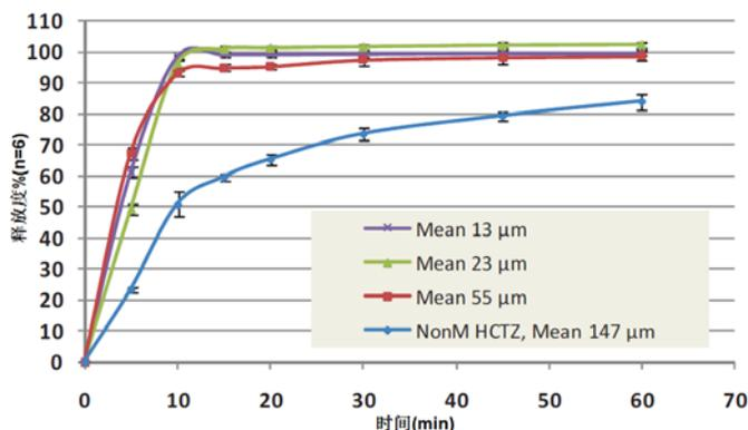
图 3. 含善达/微晶纤维素 1: 1 的 10% 氢氯噻嗪配方的溶出曲线比较(n=6)
