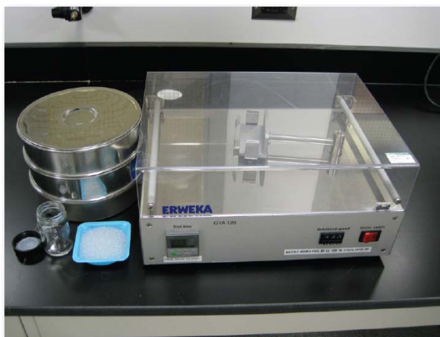
图 1. 振荡脆碎度测定装置(Erweka GTA 120, Milford, CT, USA)
