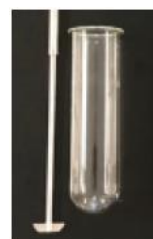
图 1: (b) 小容量溶出杯和搅拌器
