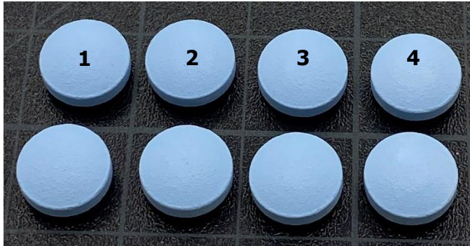
图4. 清洗前和清洗后的4%增重表层包衣的片剂: 时间T=0
