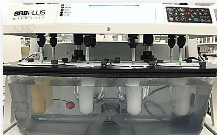
图 1. 用于高通量筛选的小体积溶出装置
