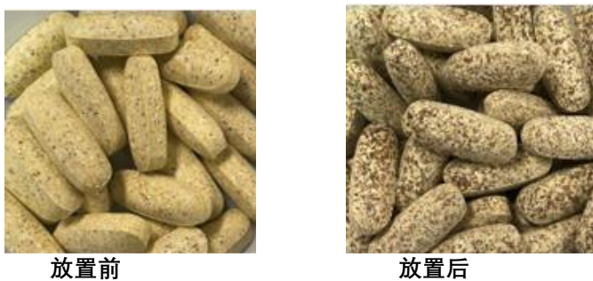
图 2. 在40°C/75% RH下储存6个月的标记和未标记的APAP片的色差 (DE)
