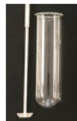
图 1: (b) 小容量溶出杯和搅拌器
