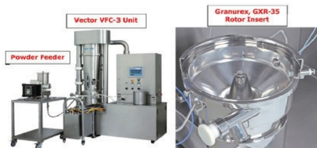
图 1: 使用配置嵌入式锥形转子的流化床进行干粉包衣*
