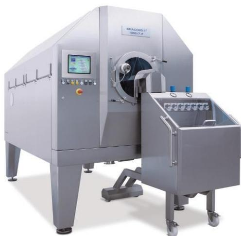
Driaconti-T Pharma 包衣机配有一个直径 100cm 的旋转打孔包衣筒。每隔 22cm，设有一组 30cm 高的隔板，将包衣筒分隔为 7 个单独的包衣室。包衣前先将目标量的素片加入进料漏斗中预热至适当的温度，再通过预热的料斗装入第一包衣室。待每一室所需的包衣液用量达到设定值后，这些“迷你批次”的包衣片就会传送到下一个包衣室。为了实现片剂分批通过整个包衣锅，每个隔板上都安装了气动控制的翼板。激活状态下翼板完全打开，横穿各个包衣室，形成螺旋结构，包衣锅旋转一整圈就可以将片剂从一个包衣室传输至下一个包衣室。随后翼板关闭，开始下一个喷雾序列。片剂在包衣室 1 和 2 中的隔离包衣的增重(WG)为 2%(每室增加 1%WG)。在包衣室 3 至 7 中的肠溶包衣增重(WG)为 10%(每室增加 2%WG)，如图 2 所示。
